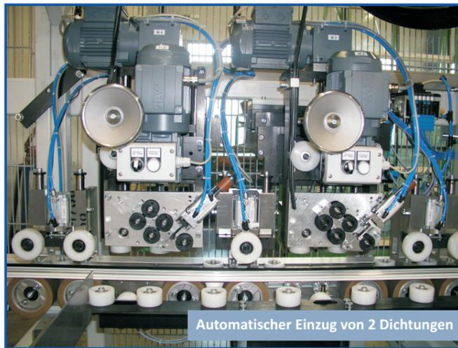
Automatischer Einzug von 2 Dichtungen
